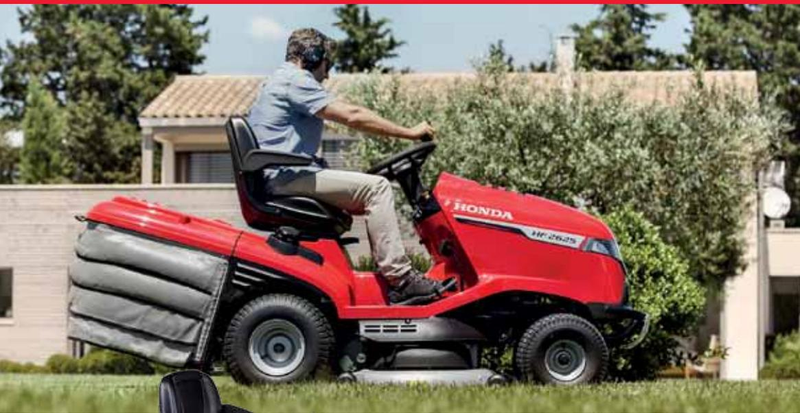
Neben technischen Highlights wie dem stufenlosen Hydrostat-Getriebe und dem zuschaltbaren Versamow-Mulchsystem überzeugen die Traktoren mit ihrer umfangreichen Komfortausstattung: LED-Tagfahrlicht, LCD-Display, Tempomat, Handyfach und USB-Ladedose.
